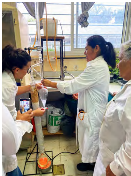
Mujeres del Laboratorio Popular realizan destilación por arrastre de vapor, extrayendo aceite esencial e hidrolato de orégano cosechado por una de ellas
