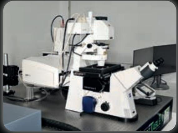
Es especialmente útil en investigaciones de las ciencias de la vida. Incorpora un detector avanzado Airy Scan II, que permite al menos duplicar la resolución lateral en comparación con los microscopios confocales convencionales. Ofrece una gran resolución temporal, ideal para estudios dinámicos en 3D. Cuenta con un láser infrarrojo de longitud de onda variable para excitación multifotónica (SpectraPhysics) que mejora la penetrabilidad en las muestras fluorescentes hasta 500  $\mu\text{m}$ .
