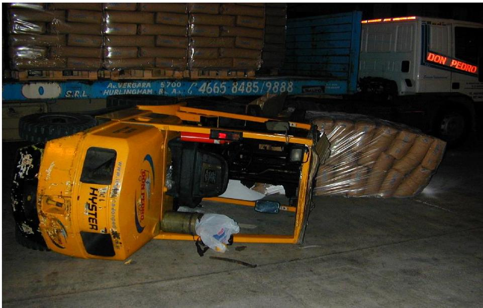
El Conductor del Autoelevador se disponía a colocar el último Pallet en el Semi. Cuando el encargado de cargas le hace una seña al Camionero. Éste interpreta que había finalizado y mueve el camión, provocando el movimiento de la carga y por ende el VUELCO del AUTOELEVADOR
