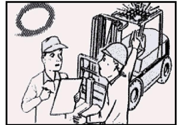
■ No opere un autoelevador dañado o defectuoso.
