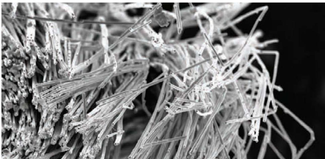
Se desarrolló una plataforma nanocompuesta destinada a la electro-oxidación no enzimática de etanol, obtenida mediante la incorporación de nanohilos de níquel (NiNWs) en una matriz de pasta de carbono (CPE). Los NiNWs fueron sintetizados por electrodeposición en plantillas de óxido de aluminio y caracterizados por microscopía electrónica de barrido (SEM), espectroscopía de dispersión de rayos X (EDS) y difracción de rayos X (XRD).
