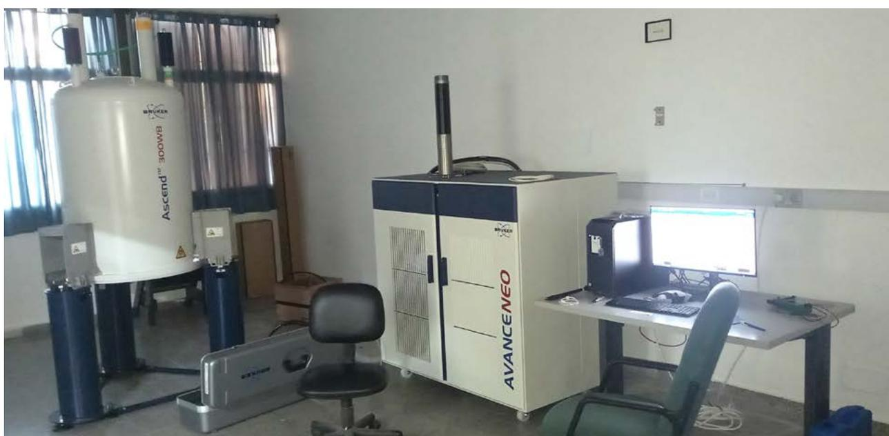
El LANAIS de FAMAFA, UNC, pone a disposición sus servicios de caracterización de compuestos sólidos por Resonancia Magnética Nuclear. Tiene aplicaciones en compuestos farmacéuticos activos y elaborados; estudios de polímeros sólidos; materiales para aplicación en catálisis; materiales sólidos para ánodos y cátodos y de baterías; industria de alimentos; determinación de tenor graso; calidad en semillas oleaginosas.
