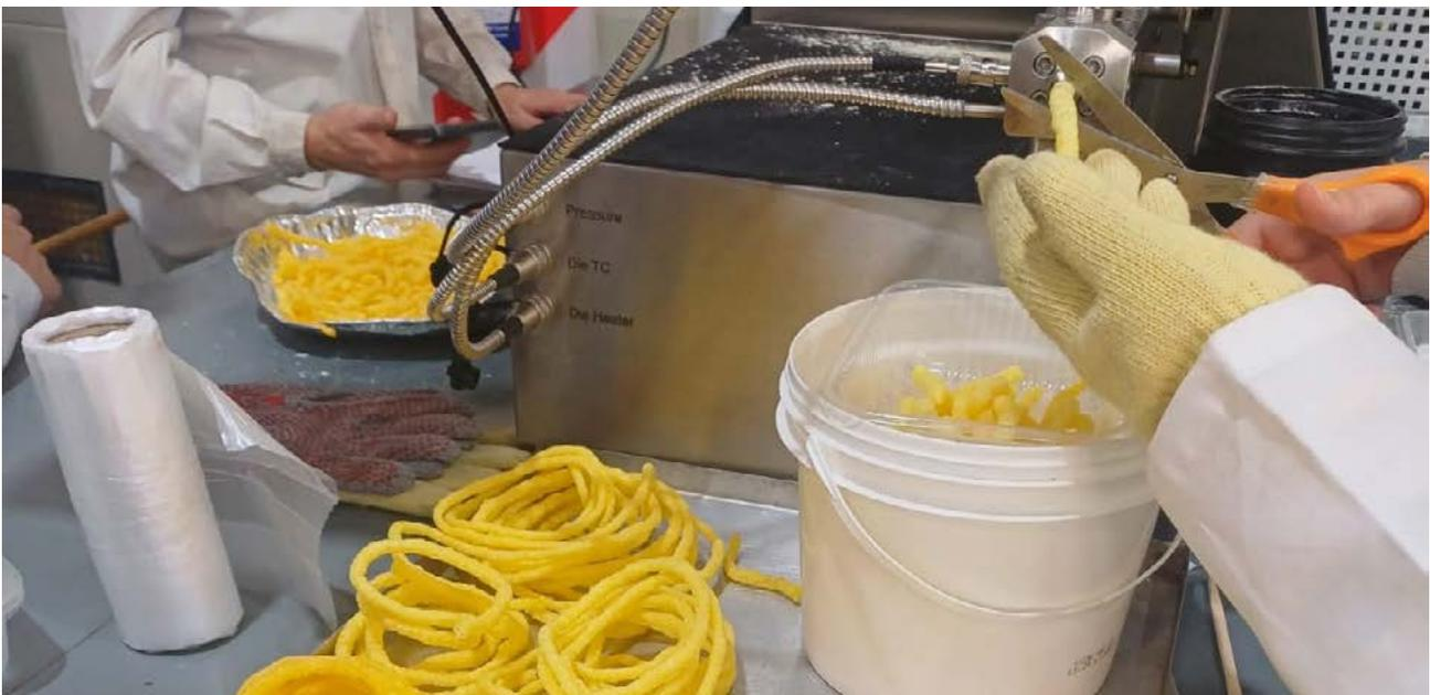
Este equipo de la marca Thermo, modelo PROCESS 11-HTS, se caracteriza por tener un doble tornillo cogedor paralelo de 11 mm, con una capacidad de hasta 2,5 kg/h y velocidad de 100 a 1000 RPM. Puede trabajar hasta 200 °C y cuenta con siete zonas con regulación de temperatura. Los tornillos se ensamblan en función del grado de cizalla y trabajo que se requiere aplicar.
